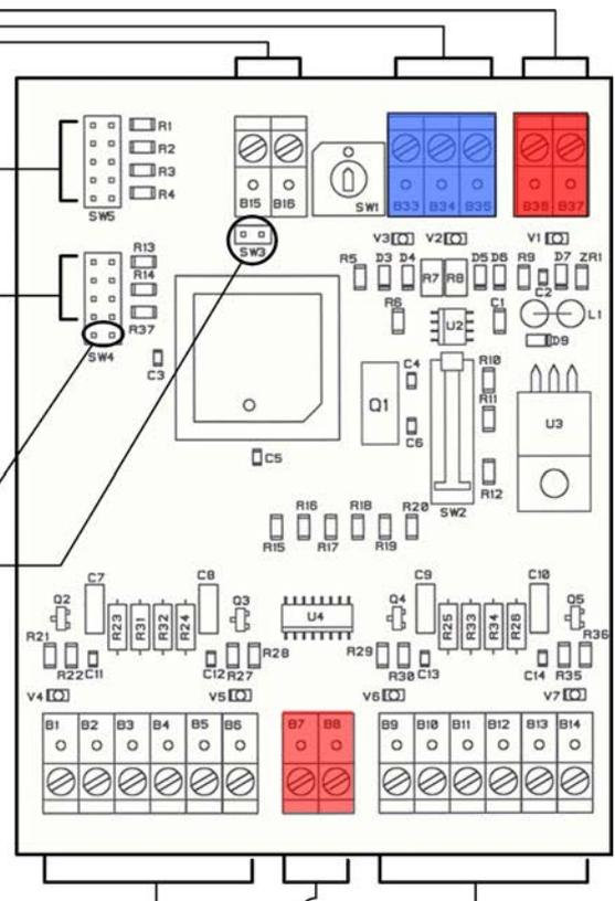
Protection des équipements : Afin d'assurer un parfait fonctionnement des équipements et éviter les interférences, raccorder le 0 volt des cartes électroniques à la terre.
